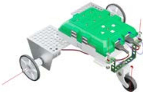
Figura 4. Instalação da roda livre e conexão dos motores Fonte: PETE
