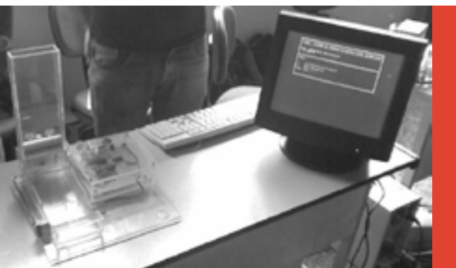
Figura 3. Sistema de inserção de matéria-prima (buffer de entrada) desenvolvido por alunos do primeiro semestre
