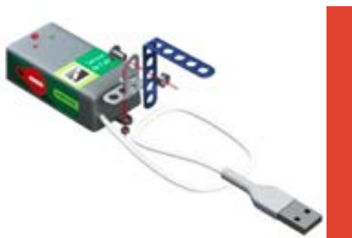
Figura 6. Montagem do sensor de faixa Fonte: PETE
