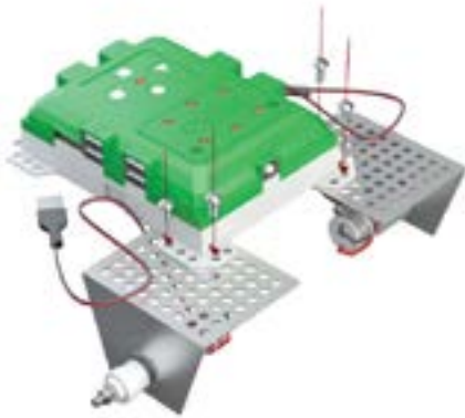
Figura 2. Montagem da base/motores Fonte: PETE
